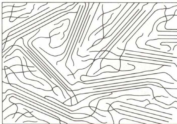
Σχήμα 0-3. Η δομή ενός ημι-κρυσταλλικού πολυμερούς (semi-crystalline)
